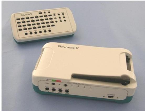
ポリメイトAP5148は、本体重さ約400gの生体アンプとBluetoothを内蔵した生体信号収録装置です。携帯できるよう小型・軽量化を図り、脳波、筋電図、心電図、眼球運動、いびき、呼吸、体位、脈波、SpO2などの生体信号をCFメモリーカードに最長約15時間以上の連続収録ができます。また、PCとUSBまたはBluetooth接続することにより、計測条件設定、リアルタイムモニターが行えます。
